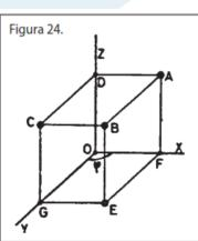
Se llama coeficiente de reducción del sistema y se representa por la letra  $\mu$ , al valor de la cotangente trigonométrica del ángulo 2 que forma la dirección de proyección d en el plano del cuadro  $\mu$  = cotg  $\sigma$
